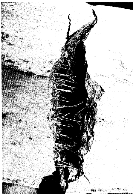
Bild 1: Gebrochener Stahlfaserbetonbalken Foto: HeidelbergCement AG
